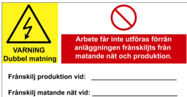
Exempel på skylt som varnar för bakspänning, används när elkopplaren inte sitter i mätarskåpet. Används främst vid strömtrafomätta anläggningar,
